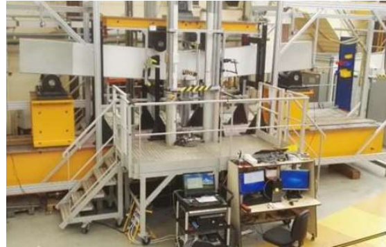
Essai de flexion sur poutre en béton armé
