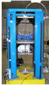
Figure 2: Mode non linéaire d'un tube de générateur de vapeur avec contact localisé à jeu. Gauche : Dispositif expérimental EDF. Droite : diagramme fréquence-énergie
