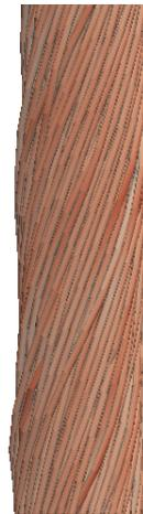
*Modèle éléments finis d'un câblé textile*
