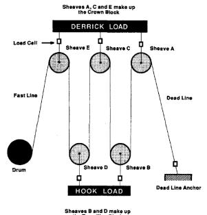
Un câble passe d'un bloc à l'autre via ce système de poulies. Une de ses extrémités est fixée au sol, et la longueur de câble entre cette fixation (*Dead Line Anchor*) et le *Crown Block* est appelée *brin mort* (*Dead Line*). À son autre extrémité le câble est enroulé autour d'un *treuil* (*Drum*), et on ajuste la hauteur du *Traveling Block* en déroulant ou enroulant du câble. On appelle *Fast Line* la longueur de câble entre le treuil et le *Crown Block*.
